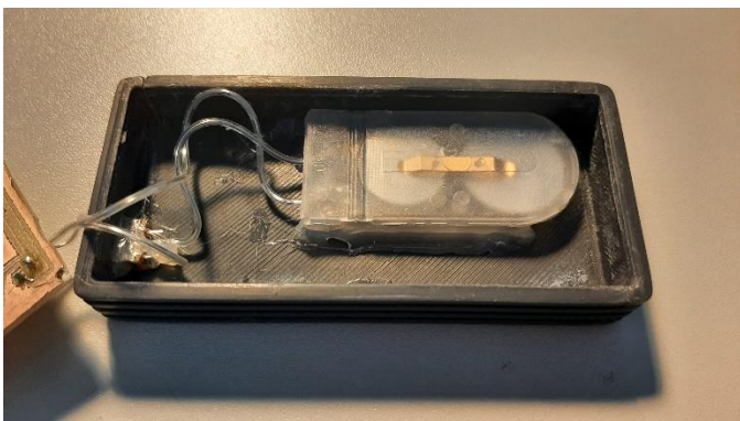
afbeelding 17 De batterijhouder die net te hoog was.
